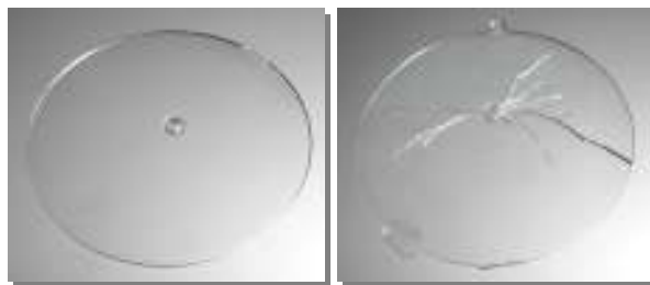
TROGAMID® myCX 非晶性ポリアミド ※共に耐薬品テスト後のサンプル
